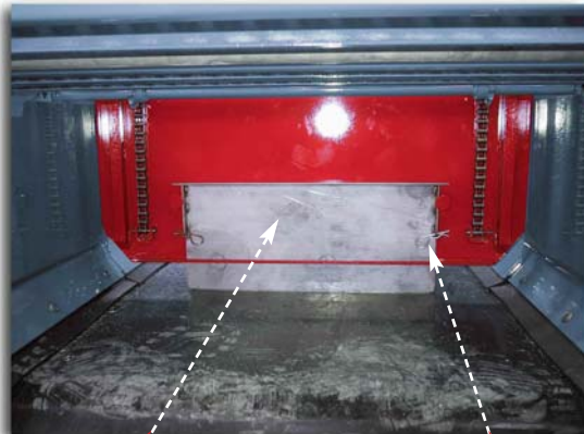
TRAPPE GUILLOTINE EN POSITION TRAVAIL
